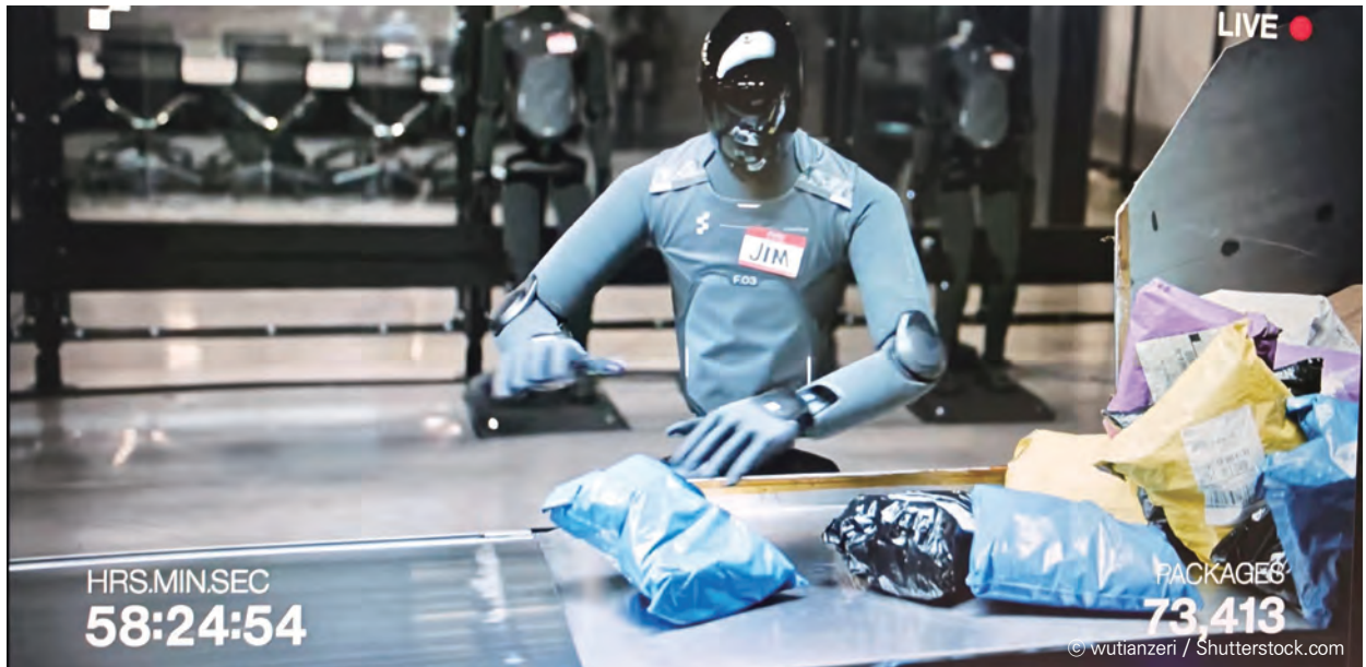
사람 개입 없이 200시간 이상 연속 작동한 미국 '피규어(Figure) AI'의 택배 분류 로봇
